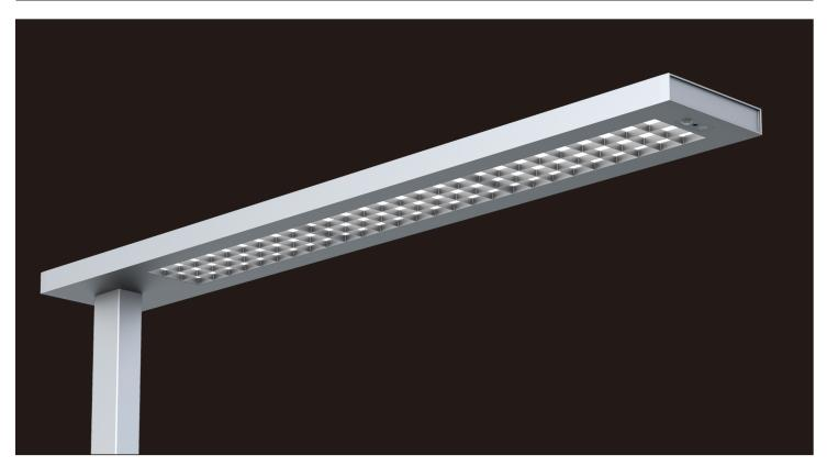
KISS-F发光部分是在传统网格设计的基础上,采用LED技术并优化结构和防眩光设计实现的,内置透镜和高反射率PC成型材料,提高了光线的均匀性和效率。中间层配置扩散板和棱镜透明板,实现照度均匀,将UGR眩光值降低到14以下。最外层还配置方形防眩光罩,对余光进行CUTOFF处理。达到均匀、柔和、舒适、低眩光的照明效果。配备大功率间接照明,通过更宽的光束角度为周围空间提供更舒适的灯光。总功率100W,下出光25W,上出光75W,单独控制,支持日光传感器和运动传感器等智能功能,可调白光,定制无线控制系统如CASAMBI、SWARM等。KISS-F光效达到110LM/W,可实现两张0.8\*1.6米办公桌的照明,可实现一个20平方米左右办公空间的照明,桌面及空间的配光效果优于其他同行业产品。
