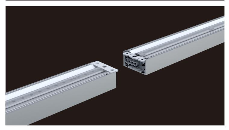
PECO是专门为办公空间走廊设计的灯具和复合应用系统,提供均匀、舒适、不眩光的照明性能。该灯具仅输出大角度偏光间接光,距天花板25CM间距可实现307米均匀照射走廊天花板,很好的解决了射灯、筒灯走廊光线分布不均的痛点或其他灯。灯具采用全新可链接设计,可直接插入实现灯具之间的连接安装,非常简单可靠。Peco拥有非常干净的设计、完美的技术细节和丰富的质感。采用铝6063外壳和高品质粉末涂层表面处理,48V直流电源,内置恒流控制单元和运动传感器(可选)。该灯支持运动传感器功能。适用于办公空间或其他商业空间的走廊应用。
